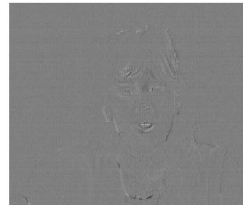
Errore di predizione utilizzando i vettori di moto
