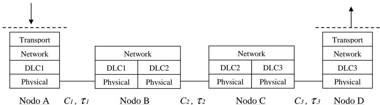
Caratteristiche dei canali di trasmissione (*full-duplex*):
