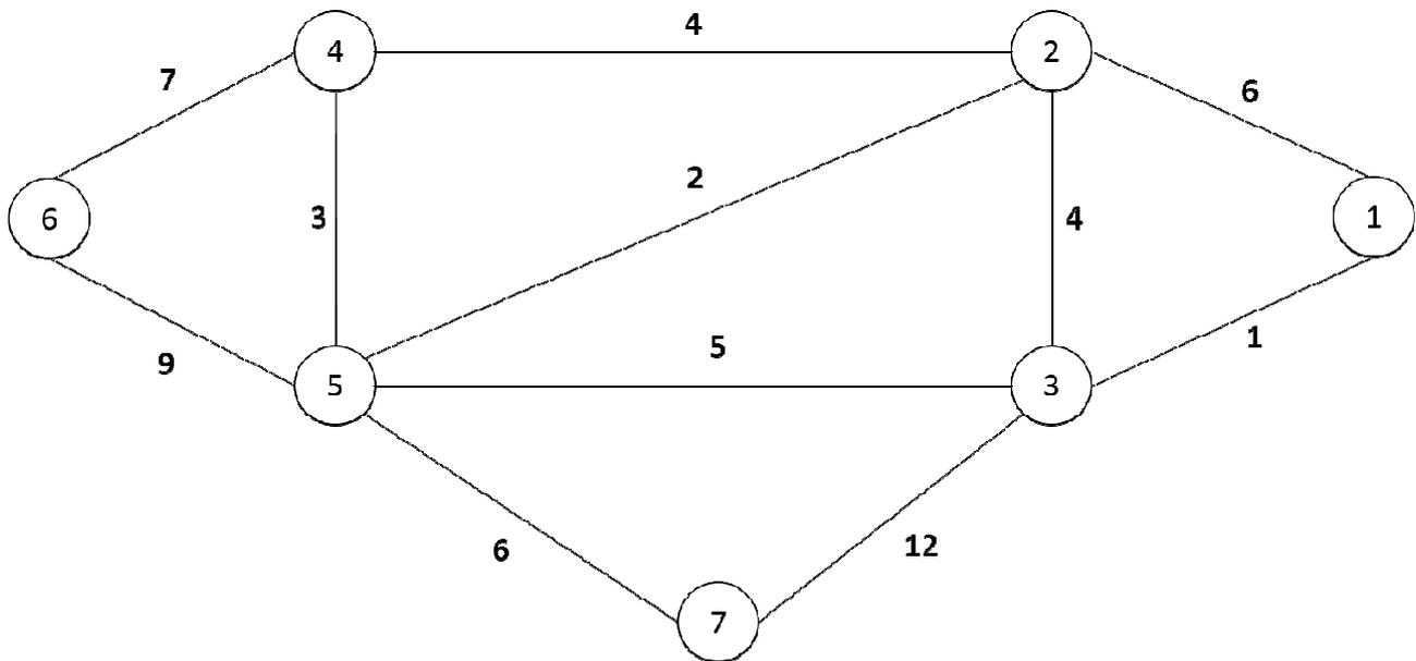
Applicando l'algoritmo di Dijkstra, calcolare i percorsi a costo minimo che terminano sul nodo 1 (mostrare nel dettaglio i vari passi dell'algoritmo).
